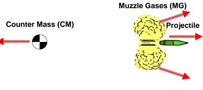
$m_{CM} \times v_{CM} + m_{MG} \times v_{MG} + m_{projo} \times v_{projo} = 0$
