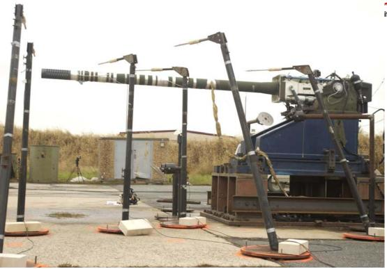
LIGHTWEIGHT 120 MM GUN ASSEMBLY AT ABERDEEN TEST CENTER – 19 OCT 04. NOTE MICROPHONES TO RECORD BLAST OVERPRESSURE, ADDITIONAL RISERS UNDER GUN 'KNEES' TO OBTAIN MORE ACCURATE GROUND REFLECTION DATA.
